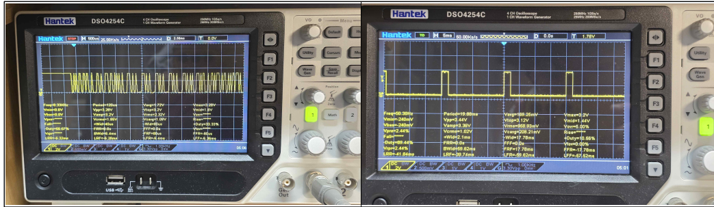
Fig. 16. 오실로스코프를 이용한 로직 전압 확인 BK-252Q(좌) ESC(우)
