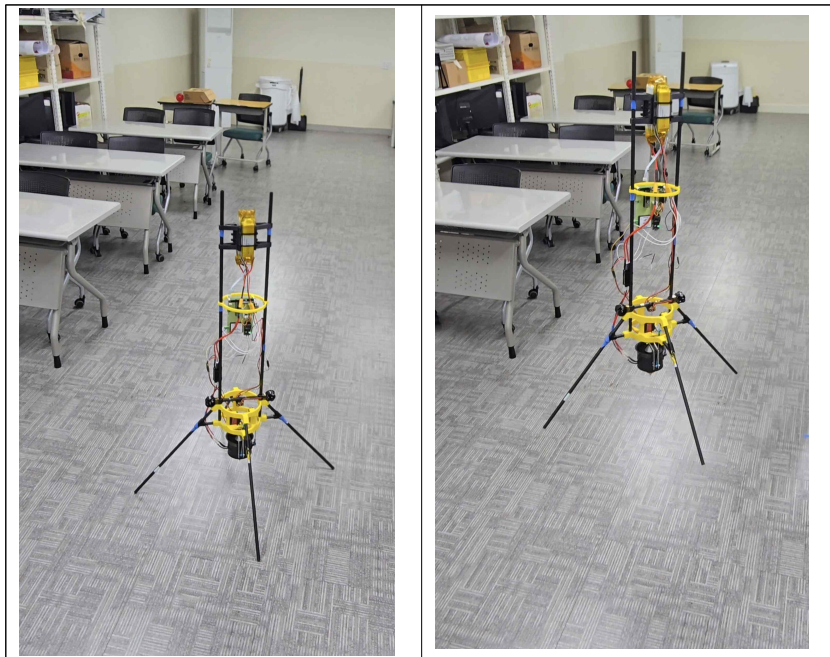
Fig. 29. VTOL 호버링 시험
